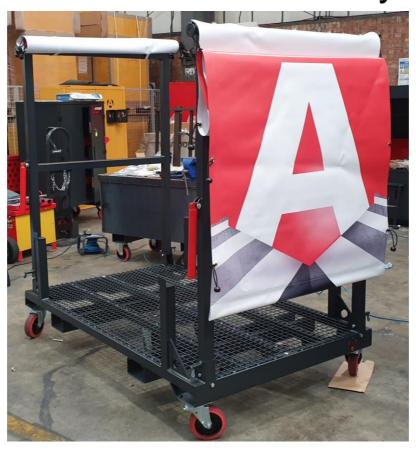
LONG LENGTH CARRYING TROLLEY WITH PATENT PENDING SAFETY AUTOMATIC BRAKE SYSTEM PLUS FIRE-RETARDANT COVERING FOR THE MATERIALS BEING TRANSPORTED.
